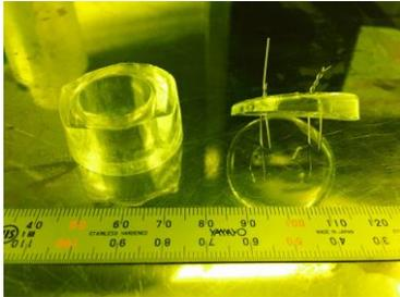
**Fig. 5:** PDMS ring-wall and cap with electrode wire.
