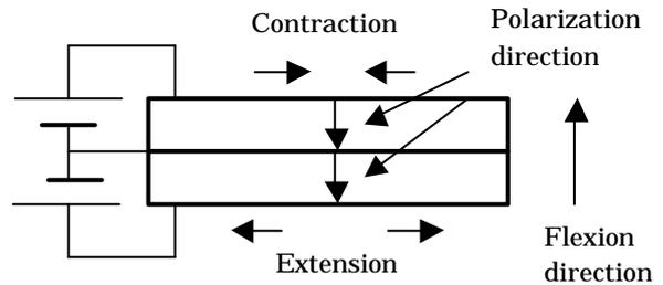
**Fig. 7(a):** Bimorph type of piezoelectric actuator.
